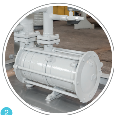
2 Bomba de Amoníaco Ammonia pump
